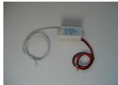
An diesem Netzteil, mit der Artikelnummer 900013, können zwei Saunawandleuchten parallel angeschlossen werden.
